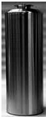
Déchet radioactif de haute activité après traitement, vitrification et insertion dans un conteneur d'acier inoxydable : c'est le « colis » destiné au stockage.
