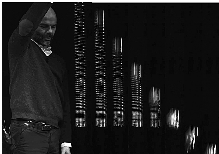
Roland Lehoucq montre ici que lorsqu'on lâche le haut du Slinky , le bas ne bouge pas tant que le ressort n'est pas complètement comprimé. L'intervalle de temps entre deux images successives est de 40 ms.
