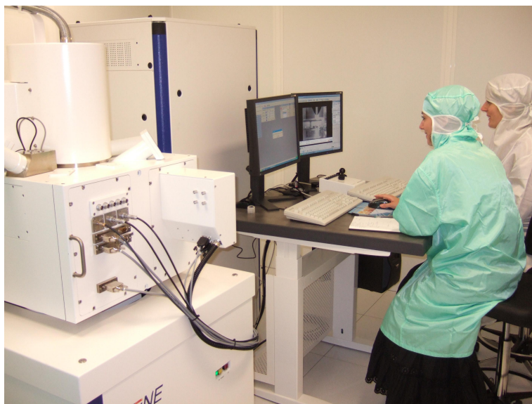
Microscope électronique d'inscription avec une résolution d'écriture de 20 nanomètres (photo M. Rosticher).
